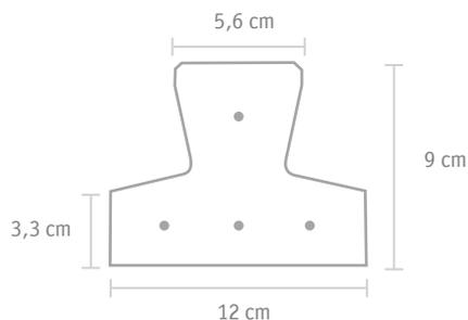
La longitud mínima del apoyo de la vigueta en vigas o muros será de 9 cm. La capa de compresión deberá tener como mínimo 4 cm de espesor y una resistencia mínima de 130 Kg/cm<sup>2</sup> (H13 - correspondiente a una dosificación en volumen 1:3:3).
